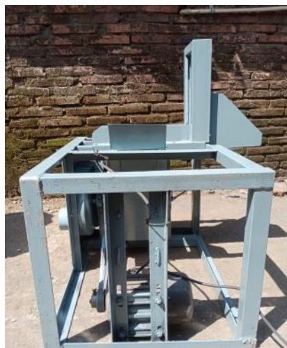
Gambar 3. Mesin perajang ubi jalar
