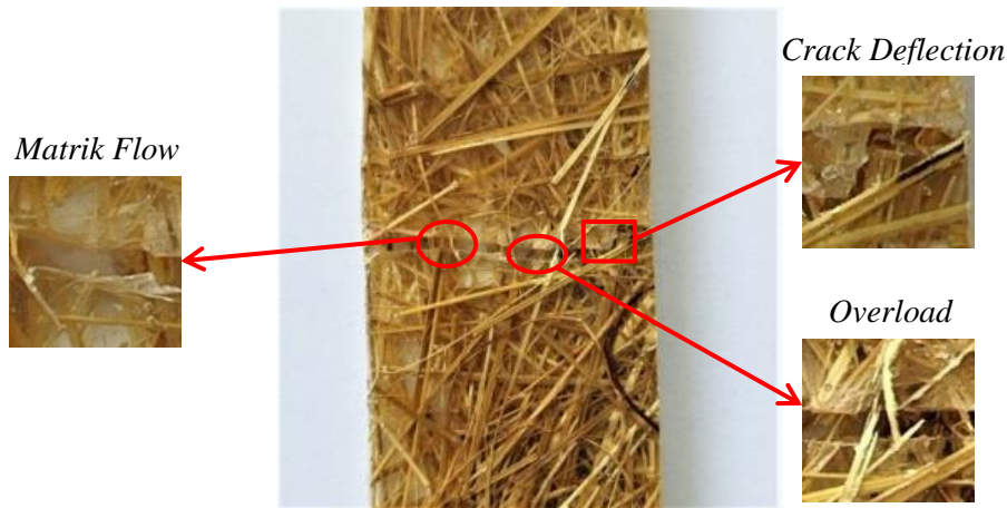
Gambar 7. Foto Makro Patahan Tarik
