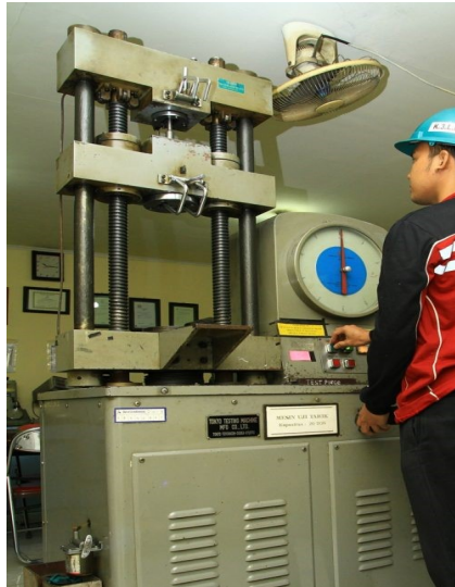
Gambar 3. Mesin uji tarik [11]
