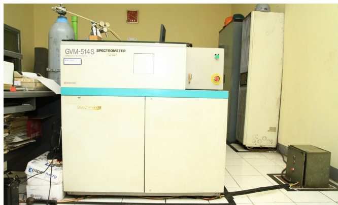
Gambar 4. Mesin uji komposisi kimia ( spectrometer ) [11]
