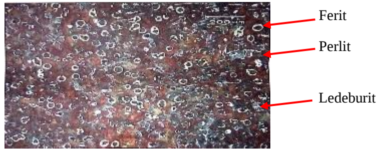
Gambar 4. Hasil uji metalografi dengan kandungan Mg 0,0380% (sesuai standar) dengan pembesaran 100 X
