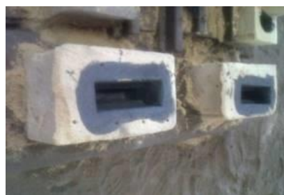
Gambar 3. Cetakan pasir CO 2 proses Y blok
