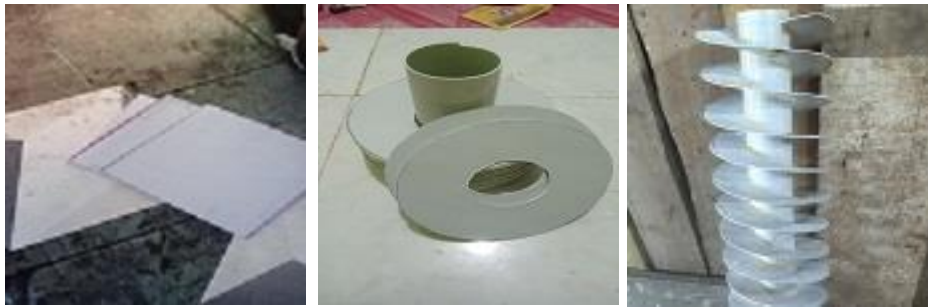
Gambar 2 Pembuatan Turbin Ulir
